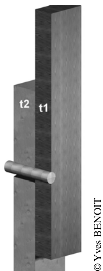
Schéma 74 : rupture du bois dans la deuxième pièce 2
