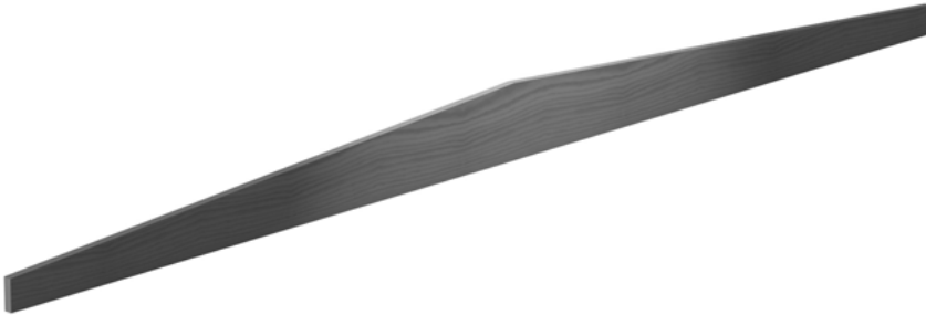
Schéma 45 : poutre intrados courbe à inertie variable
