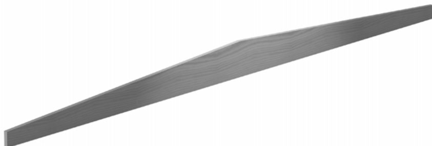
Schéma 49 : caractéristiques de la poutre à double décroissances
