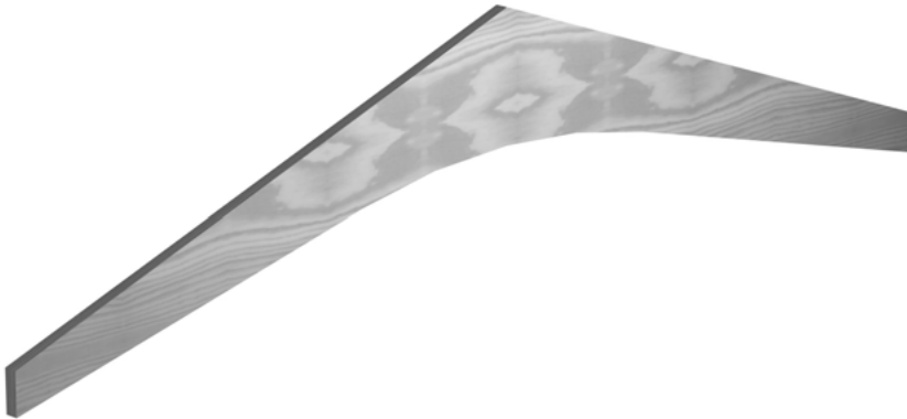
Schéma 46 : poutre courbe à inertie constante
